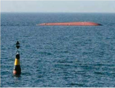
Vraget af OMER N blev hurtigt afmærket af Farvandsvæsenets inspektionsfartøj JENS SØRENSEN. På billedet set vraget og en af de udlagte kompasafmærkninger.
