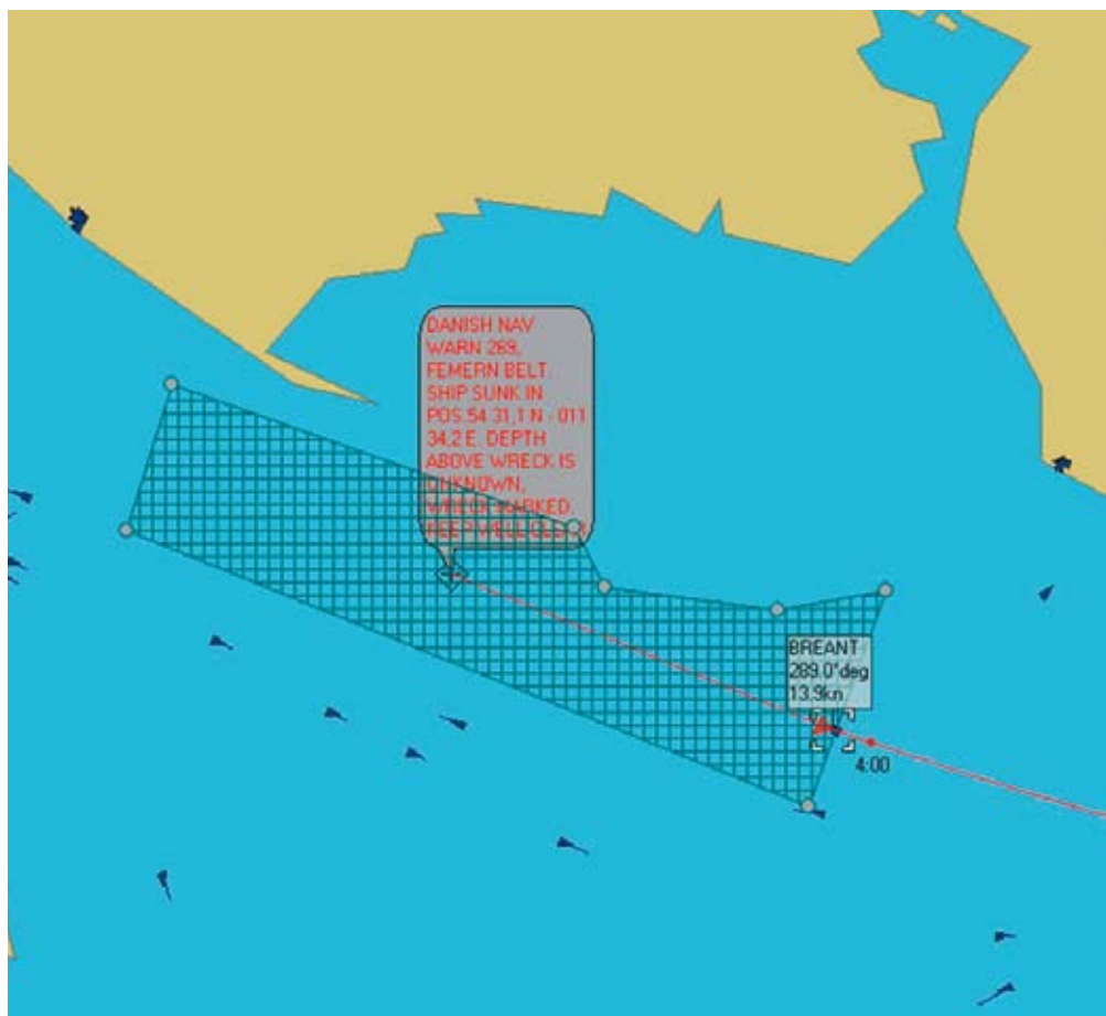
Et skib modtager automatisk en navigationsadvarsel via det landbaserede AIS-system, når det sejler ind i området omkring vraget af OMER N.
